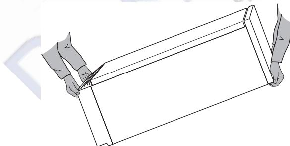
2. Чтобы задвинуть холодильник на предназначеннное ему место, осторожно надавите на дверцу сверху и слегка отклоните холодильник назад. Таким образом вес холодильника будет приходиться на задние колесики, благодаря чему Вы сможете его легко двигать.
