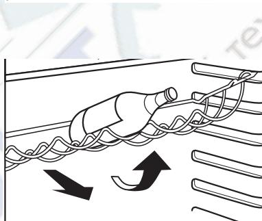
1. Для этого надо выдвигать полку для бутылок вперед до тех пор, пока не появиться возможность ее приподнять, и потом задвинуть ее на следующий по высоте уровень.
