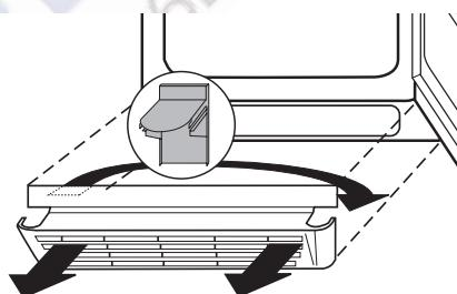
2. При закрытой дверце морозильной камеры вывинтите винт с крестообразно-шлифцовой головкой из нижнего крепления дверцы и снимите крепление движением вниз.
