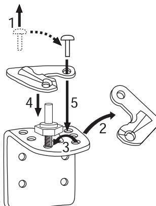
4. Снимите справа внизу крепежные элементы дверцы (1). Переставьте корпус дверной петли с левой стороны на правую (2). Имеющиеся в комплекте поставки крепежные элементы дверцы вставьте в дверцу слева внизу (3). Движением вперед осторожно снимите дверцу и отставьте ее в сторону.
