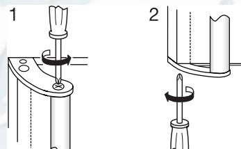
10. Отвинтить верхнее крепление ручки от дверцы (3) и привинтить его к дверце снизу справа (4).
