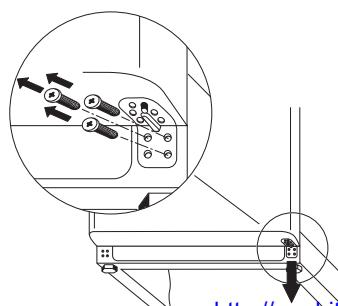
3. Снимите с дверной петли крепежные элементы дверцы (1, 2). Переставьте стержень дверной петли из правого отверстия в левое (3). Установите на стержень дверной петли крепежные элементы дверцы (4,5), имеющиеся в комплекте поставки.
