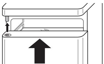
7. Нижнюю дверную петлю со стержнем вставьте в дверцу слева внизу и наглухо завинтите.
